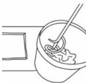
**PASSO 1:** Misturar mecanicamente 4 litros de **HARD-DEFENSE ELASTIC** + 20 kg de argamassa colante tipo ACI, acrescentando a quantidade de água necessária de acordo com o método de aplicação (4.2) (pintado com rolo/pincel/trincha ou aplicado com desempenadeira de aço lado liso);
