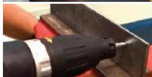
3º) Coloque a ponta do parafuso no pré-furo e com ajuda da parafusadeira aperte o parafuso até que ele esteja totalmente fixado.
