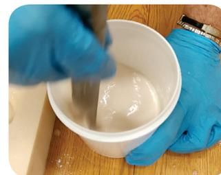
4) No recipiente com o endurecedor já pesado, adicione metade da carga e misture até obter uma boa homogeneização. Importante! Não use a espátula que foi utilizada para misturar a resina.
