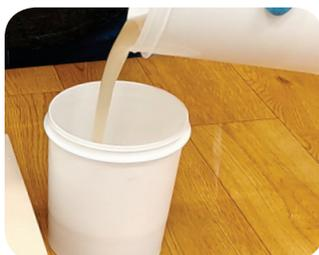
5) Adicione a mistura da resina à mistura do endurecedor e homogeneize bem para não haver aglomeração.
