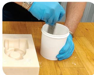
3) No recipiente com a resina já pesada adicione metade da carga e misture com uma espátula limpa de metal ou plástico até obter uma boa homogeneização. Não use espátulas de madeira.
