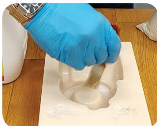
1) Aplique o Desmoldante Z 15 LC (pincelável) ou Desmoldante Z 25 LE (spray) sobre o ferramental devidamente limpo e espalhe bem por toda a superfície.
