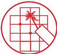
Para desobstruir a passagem da resina, utilize a Bomba Sopradora Hard para fazer a limpeza após a furação.
